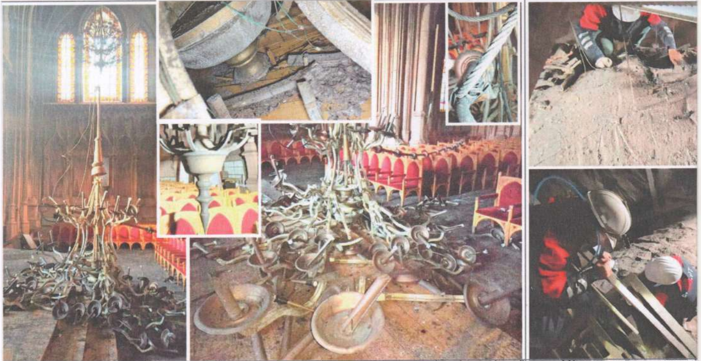
Місце падіння центральної люстри середохрестя на сходи дерев'яної сцени та конструкції надпідвального перекриття. Обрив металевого троса Ø10 мм ручної лебідки на горіщі. Руїнування різків каркасу, розкриття паяних швів трубок, стилізованих під свічки, вигорання декоративних металізованих покриттів. Термічні пошкодження електропроводки ламп та металевих елементів
